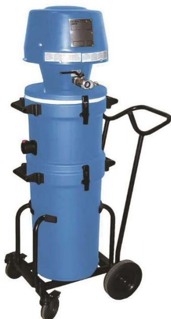
Un aspiratore ad alta capacità per l'aspirazione di sostanze grasse e materiali ad alta viscosità. Il materiale viene raccolto in un sacchetto di plastica per consentire un rapido e semplice svuotamento del contenitore di raccolta. L'attrezzatura di aspirazione è realizzata per sostenere impieghi gravosi. Il contenitore è fissato al carrello tramite staffe.
