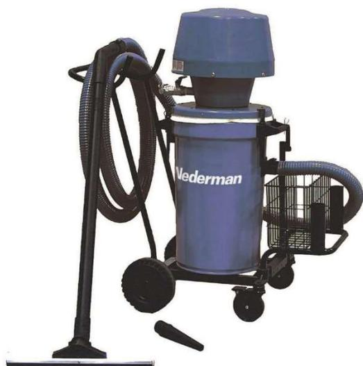
Aspiratore industriale con sistema ad unico contenitore, progettato per l'aspirazione di materiali secchi e umidi su brevi distanze. Aspiratore versatile adatto a diversi settori ed applicazioni. L'apparecchiatura di aspirazione è leggera e facile da utilizzare. È disponibile con diverse testate di aspirazione: NE22 – NE32 – NE42 – NE52\*.
