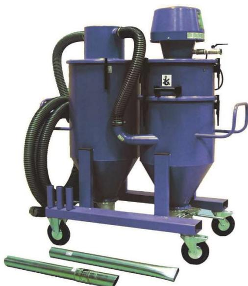
Potente e flessibile aspiratore industriale installato su carrello e dotato di un gruppo di scarico di graniglia e polveri in un silo pre-separatore. La sabbia pulita può essere svuotata in un recipiente, in un sistema di alimentazione o in un contenitore a pavimento. La polvere viene catturata dal filtro NFC e viene raccolta nel secondo silo. Indicato per essere utilizzato nei reparti di sabbiatura per il recupero della graniglia abrasiva, per la pulizia di scafi o altre strutture in acciaio.
